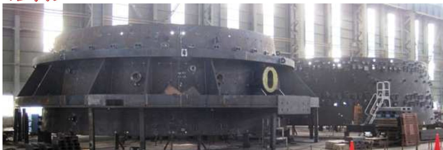
高炉マンテル
